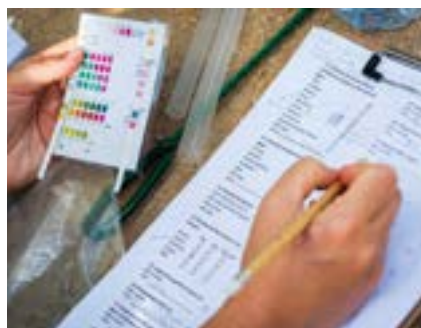
FIGURA 3 Comparação da fita contendo os parâmetros químicos amostrados com a escala de referência (Créditos: Gonçalo Mota).
