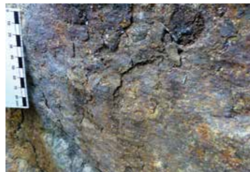
FIGURA 11 Segmento da falha de Pias, perto do núcleo de moinhos. A presença de estrias indica o sentido de movimento dos blocos. Neste caso, a direção e assimetria das estrias, não observáveis na figura, indicam que se trata de um desligamento direito. Sem prejuízo das premissas associadas ao movimento relativo de objetos, pode-se considerar que o bloco da direita se deslocou em direção ao observador. Não sendo possível quantificar a verdadeira extensão do deslocamento, a paisagem fornece algumas pistas: a atividade da falha provocou o encaixe do rio Sousa e influenciou a direção do seu percurso. Os moinhos existem por consentimento geológico: o estreitamento causado pela falha permitiu a fácil construção de açudes e o declive local permitiu os caudais necessários ao acionamento dos aparelhos.
