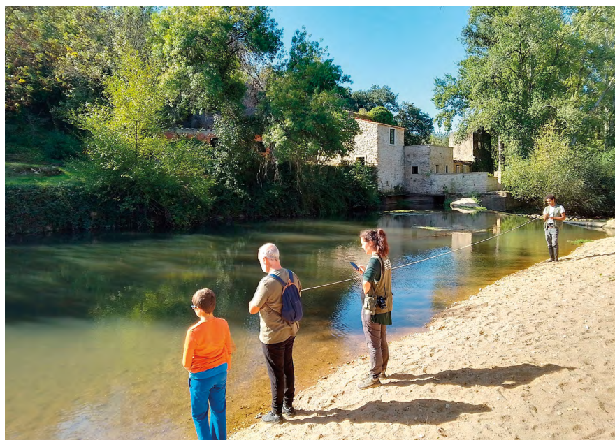
FIGURA 9 Medição da velocidade média do caudal (Créditos: Hugo Ribeiro).
